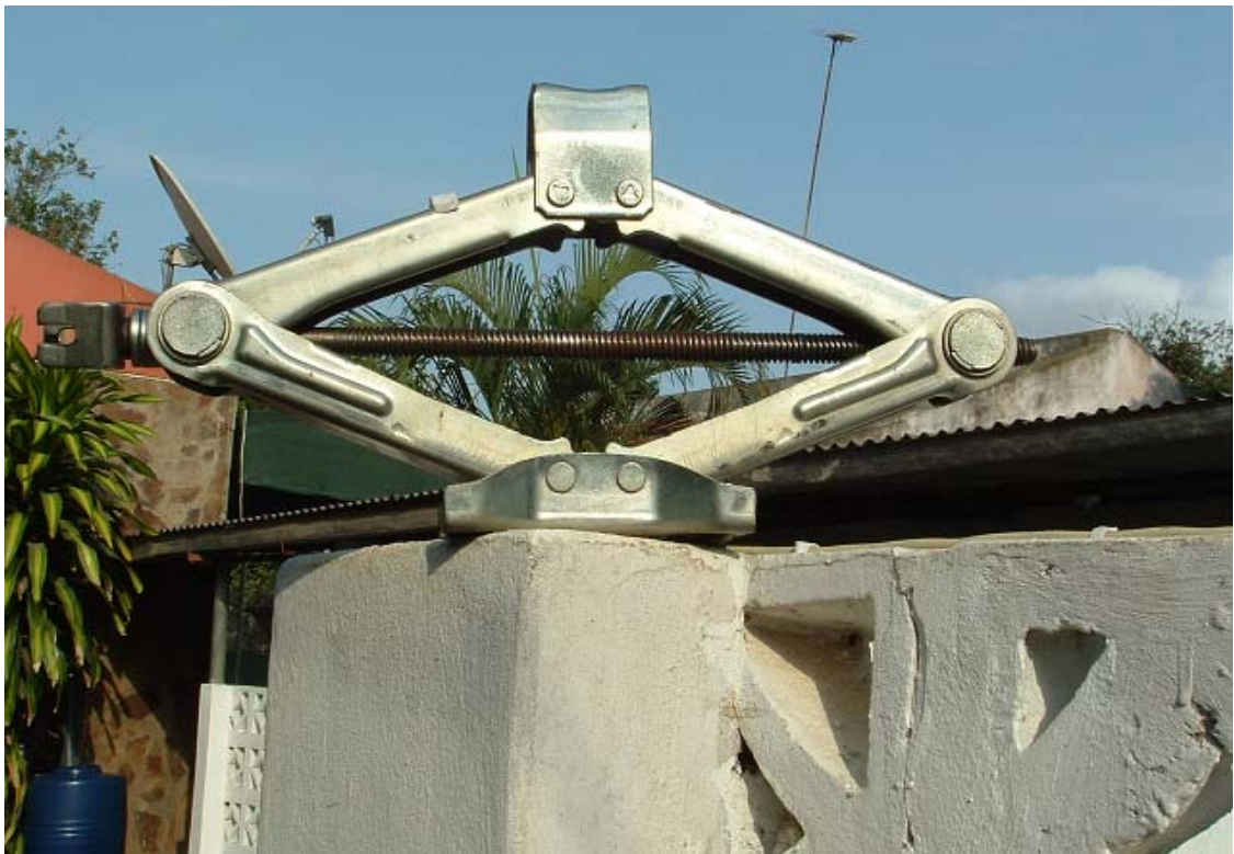
Fig.5. Macaco mecânico do tipo losângulo para carrinhas
