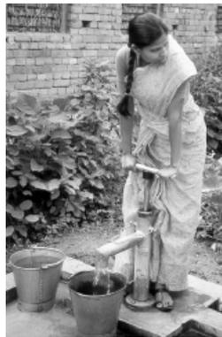
*Figura 2. Bomba de acção directa de pequena profundidade*
